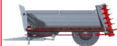
Antriebsstrang mit Getriebe unter der tiefergelegten Achse (ideal für Hanglagen).
